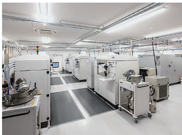
金属3Dプリンタ（金属粉末を熱で溶かしながら造形するため多種多様な造形が可能）の保有台数は国内トップクラス
