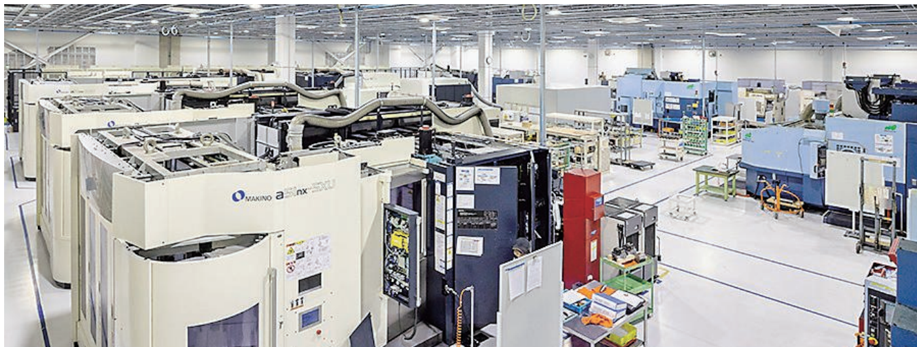
5軸マシニングセンタ（金属・精密部品の複雑な形状の3次元加工が可能）が並ぶ工場
