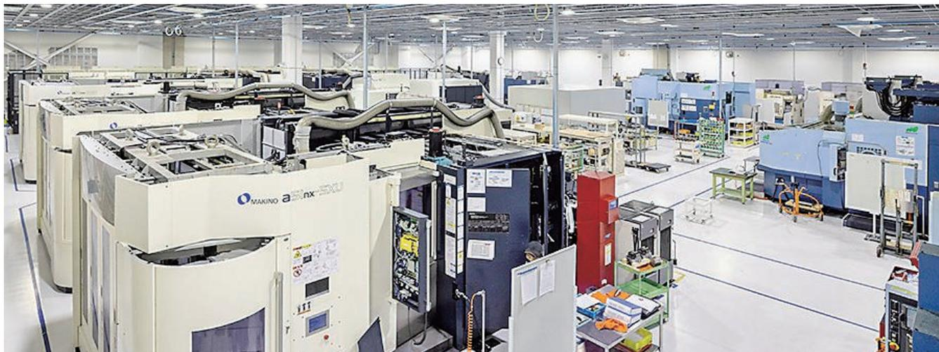
5軸マシニングセンタ（金属・精密部品の複雑な形状の3次元加工が可能）が並ぶ工場
