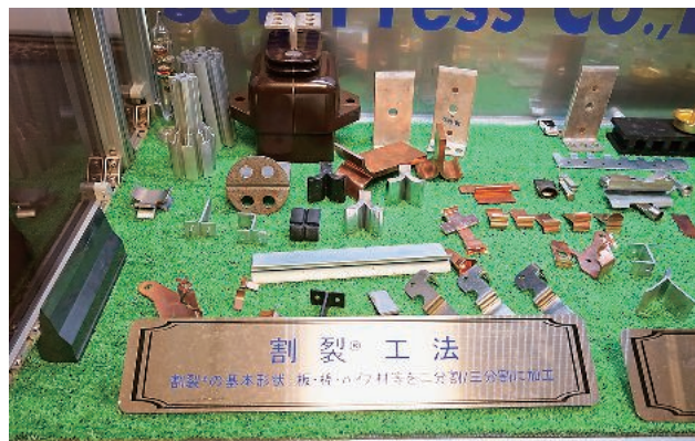
割裂工法でいろいろな形の製品が出来上がります
