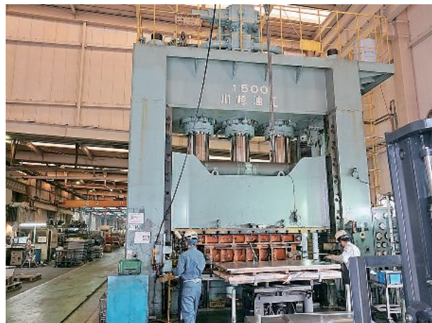
川崎工場時代から稼働する1500トン大型油圧プレス機
